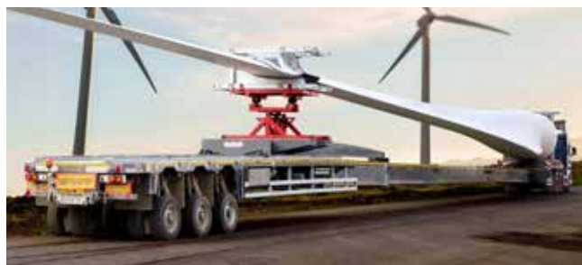
Для перевозки лопастей ветрогенераторов длиной до 70 метров разработаны узкоспециализированные полуприцепы
